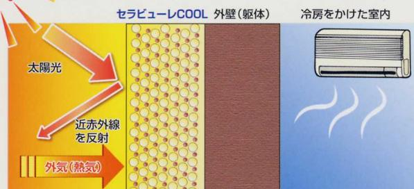
近赤外線反射型顔料及び中空セラミックバルーンにより、近赤外線を効率よく反射し外壁の温度上昇を抑制します。
