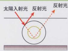
セラミックバルーンと一般顔料の反射メカニズム
