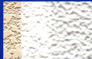
旧塗膜 WBリメイク弾性フィラーEPO 1液ワイドウォールSi
