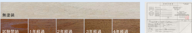
▲促進耐候試験によるU-OILスーパーハードの色落ちの経過
