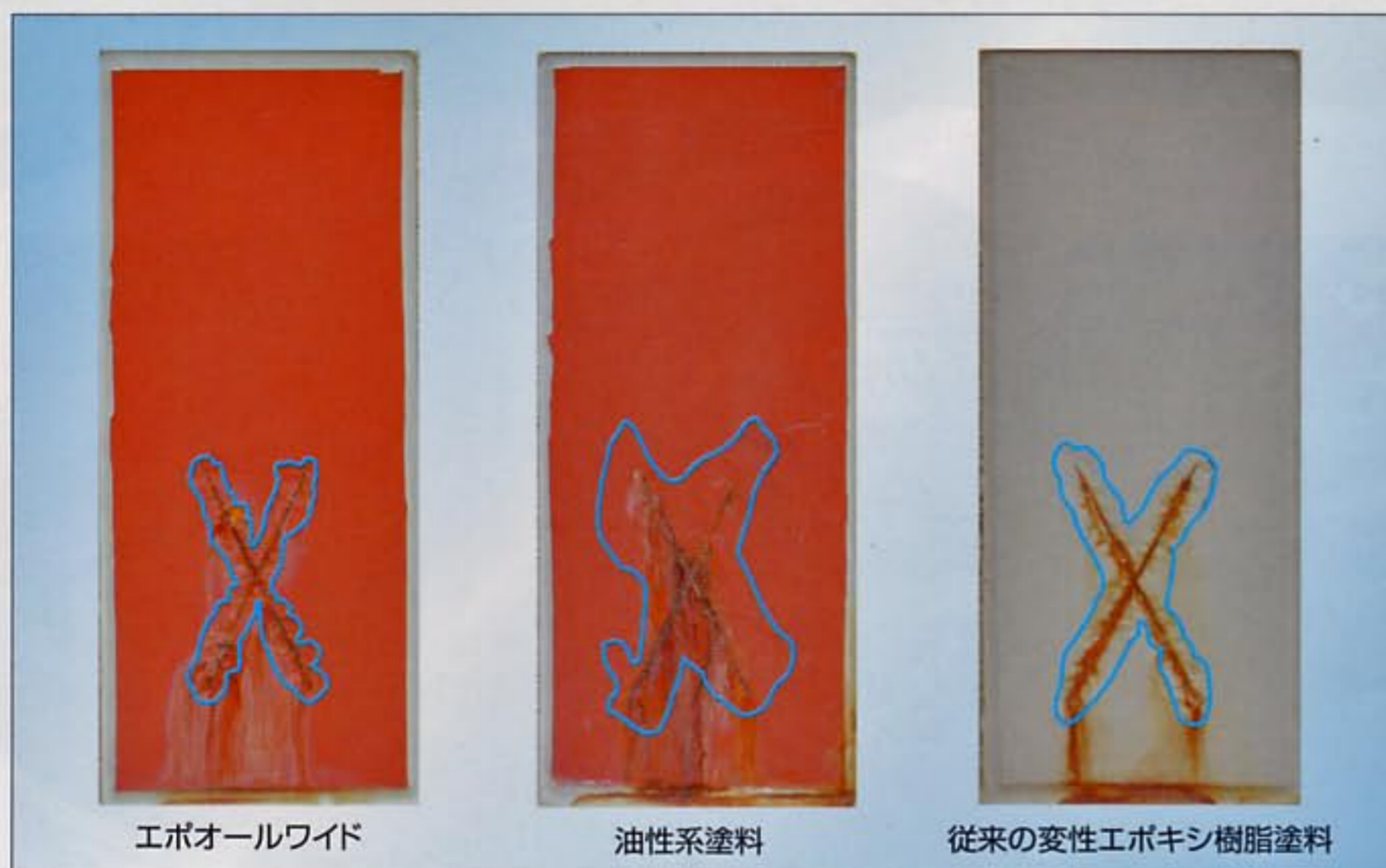
線はカット部からの塗膜の浮上がり範囲を示します。
